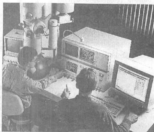
სურ. 8-11. (ა) სინათლის და ელექტრონული მიკროსკოპების მუშაობის პრინციპების შედარება. (ბ) ელექტრონული მიკროსკოპი და მასთან მუშაობის მაჩვენებელი ფოტოსურათი
